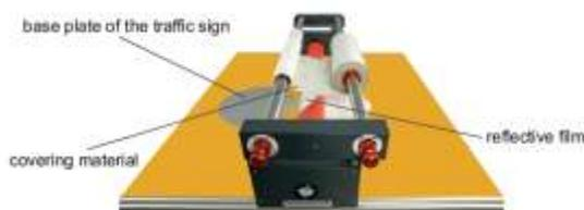
Si resulta necesario aplicar dos fragmentos de laminado prismático uno al lado del otro (unión), no deben solaparse. El hueco debe ser de aproximadamente 1 mm (0,04 pulgadas), según el formato. Asegúrese de que se pegue siempre el lado derecho de la película con el lado izquierdo, así se garantiza la orientación uniforme de la estructura alveolar de la película (consulte la figura siguiente).
