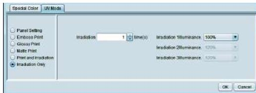
No se imprime en absoluto y lleva a cabo la irradiación solamente. Si el curado no es suficiente, se puede realizar la irradiación adicionalmente.
